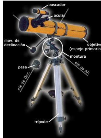
Telescopio Newton con montura ecuatorial alemana sobre trípode de aluminio.
